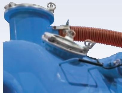
セパレーター及び補給水タンクは、幅を最小限に抑え、最大の容量を確保できるよう平面型鏡板を採用。(ワイドキャブはR形状の鏡板になります。)
